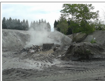
Refroidissement de laitiers de « fraîche production » avec émission de vapeur d'eau
